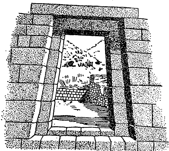
Las ventanas trapezoidales son otras de las singularidades que tipifican a la arquitectura de los incas.
